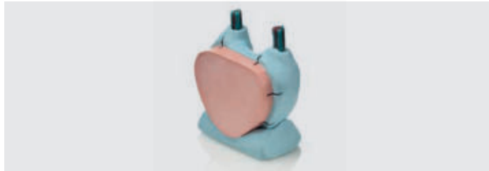
5. Basiskonstruktion aus Platinum 95 zur Aufrechterhaltung der senkrechten Position, Markierung von Bezugspunkten zur Kontrolle der richtigen Positionierung des Silikons
