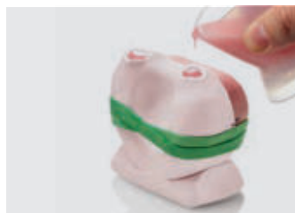
13. Der Gussvorgang ist beim Austreten des Kunststoffes am gegenüberliegenden Eingusskanal abgeschlossen
