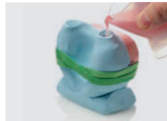
14. Den Kunststoff in einen der beiden Eingusskanäle gießen
