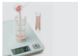
7. Das Pulver wiegen, dann das Monomer abmessen und mischen. Dazu zuerst das Monomer und dann das Pulver hinzugeben
