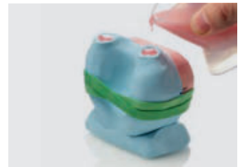
15. Der Gussvorgang ist beim Austreten des Kunststoffes am gegenüberliegenden Eingusskanal abgeschlossen
