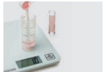
11. Das Pulver wiegen, dann das Monomer abmessen und mischen. Dazu zuerst das Monomer und dann das Pulver hinzugeben
