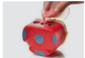
12. Den Kunststoff in den mittleren Gusskanal gießen
