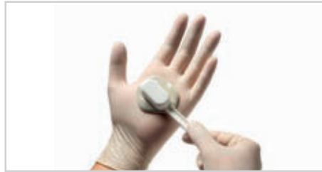
2. Zetalabor auf die Handfläche geben und den Rand des Messlöffels auf der Masse entsprechend der Anzahl Messlöffel andrücken
