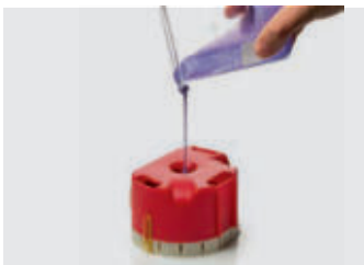
5. Elite Double 16 in die Dublierform gießen
