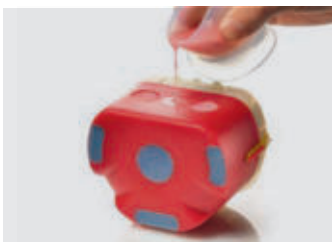
13. Der Gussvorgang ist beim Austreten des Kunststoffes aus den Seitenkanälen beendet
