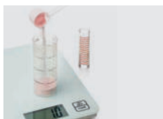
9. Das Pulver wiegen, dann das Monomer abmessen und mischen. Dazu zuerst das Monomer und dann das Pulver hinzugeben
