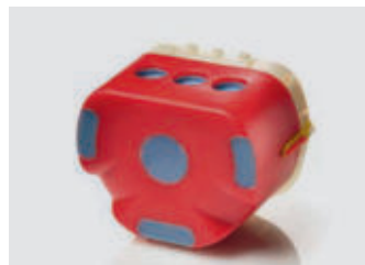
11. Die Dublierform schließen und sie in der richtigen Position mit einem Gummiband sichern
