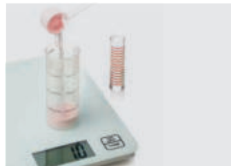
6. Das Pulver wiegen, dann das Monomer abmessen und mischen. Dazu zuerst das Monomer und dann das Pulver hinzugeben
