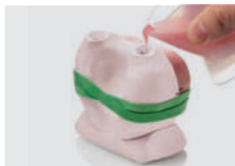
12. Den Kunststoff in einen der beiden Eingusskanäle gießen
