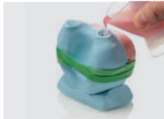
12. Den Kunststoff in einen der beiden Eingusskanäle gießen
