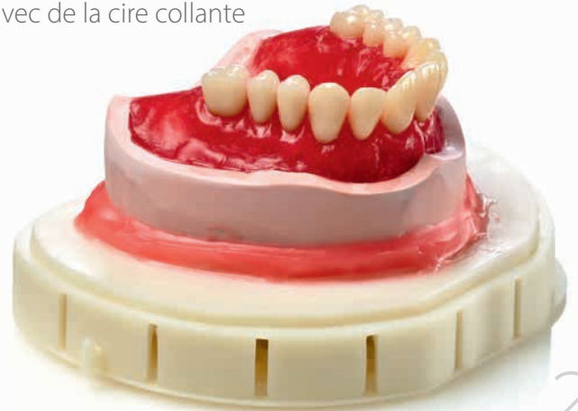
Fixation du modèle sur la base du moufle, avec de la cire collante
